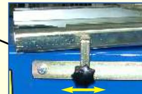
Ein wesentliches Detail ist der Drehbegrenzer (Anschlag). Dieser wird so eingestellt, dass bei der links/rechts Bewegung die Topfschleifscheibe immer innerhalb der Schleiffläche bleibt und nicht am Anfang oder Ende des Messers über die Kante schleift.
