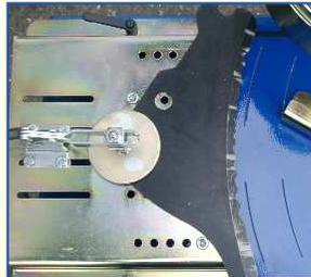
Durch einfaches Versetzen der Anschlagschrauben lassen sich Messer aller namhaften Hersteller optimal positionieren. Um die Messer absolut sicher klemmen zu können, kann der Waagrechtspanner in Höhe und Länge angepasst werden.
